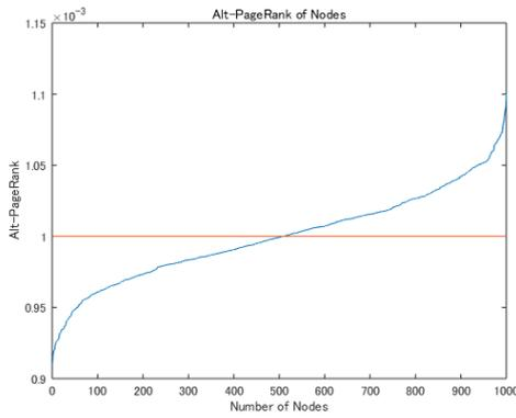
Fig. 2: シミュレーションの結果.  $N = 1000$  ノードの強連結なグラフについて Alt-PageRank を計算し, 大きさの順番に並べたのが青線, Alt-PageRank の基準として  $1/N$  をプロットしたものが赤線.
